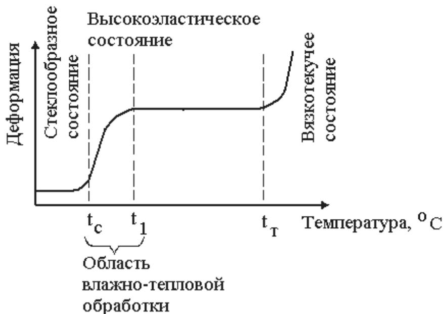
Рис. 23. Термодинамическая кривая монолитного полимера
