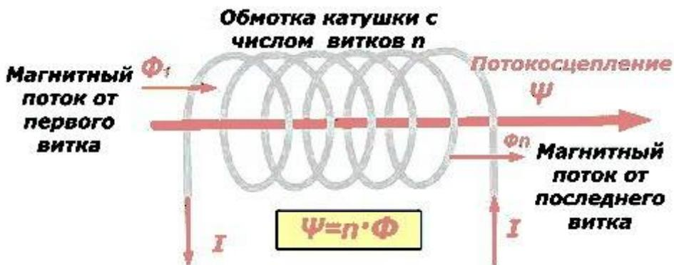
Потокосцепление  $\Psi$  измеряется в веберах, и равно:  $\Psi = n * \Phi$ .
